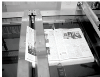
Principe de fonctionnement du tourne page automatique du Digitizing Line 3000 d'I2S-4DigitalBooks
