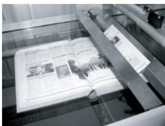
Principe de fonctionnement du tourne page automatique du Digitizing Line 3000 d'I2S-4DigitalBooks
